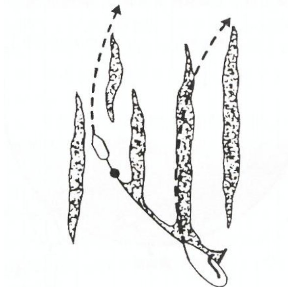
图 5-8 单船收油系统另加一船拖曳围油栏，以增加围油率
